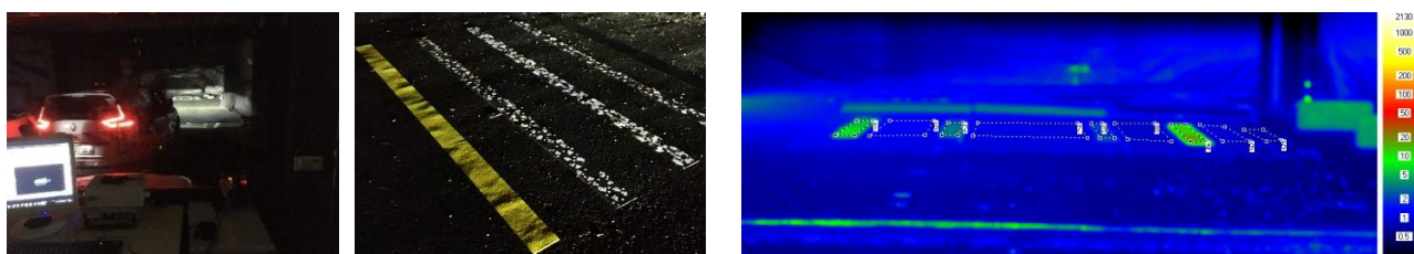
De gauche à droite : mise en place d'un véhicule dans la plateforme, marquages testés avec différents niveaux d'usure, image en luminance avec mesure de chacun des marquages en conditions de brouillard léger.
